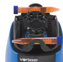
Tubos cónicos de 15 mL x 2 (colocados horizontalmente)
