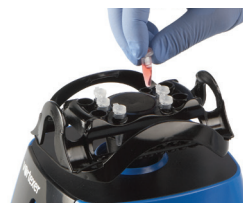
Tubos de microcentrifuga 0.5 mL x 6 (colocados verticalmente)
