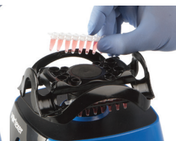
Tubos de microcentrifuga 0.2 mL (tiras) x 24 (colocados verticalmente)
